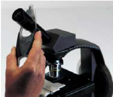
Dévisser l'oculaire avec une main tout en maintenant fermement la clé de l'autre main. Vous pouvez vous aider d'un gant en caoutchouc ou d'un morceau de feuille anglaise.
